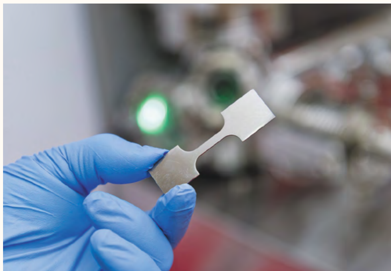
The new high-entropy alloy is extremely strong, yet ductile and flexible [2]. 新的高熵合金非常堅固，且具有良好的延展性和柔韌性 [2]。
