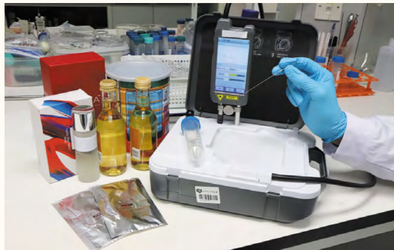
The SERS biosensing technology can be used to test contaminants in food and cosmetics. 表面增強拉曼光譜 (SERS) 的生物傳感技術可用於檢測食品和化妝品中的污染物。
