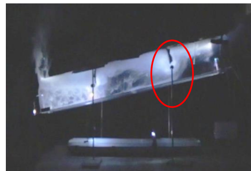
(d) Stage 4 : Spread up to the protected zone B above
