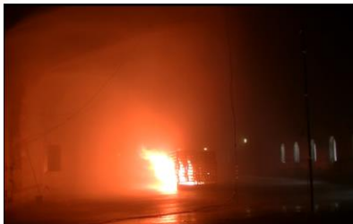
(d) 120 s after activating WFFF system
